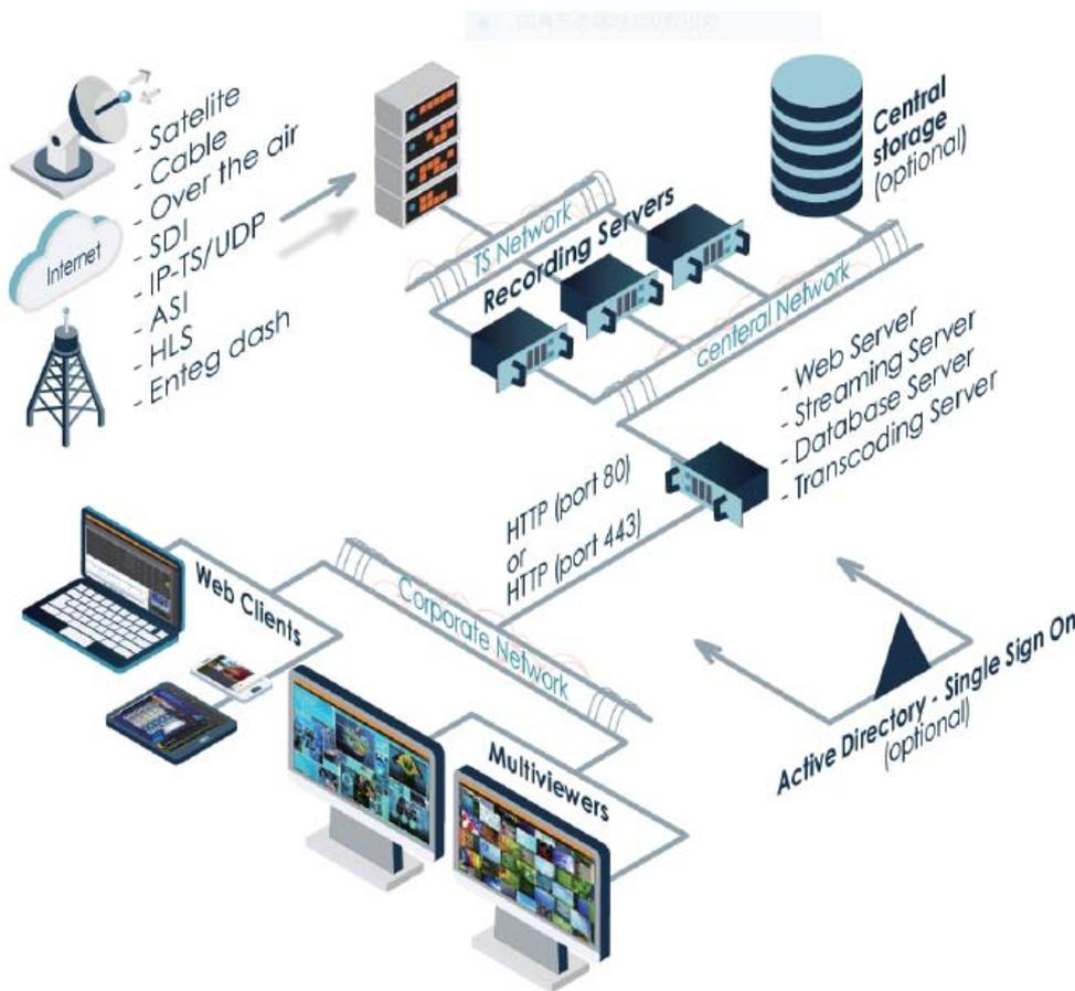
Actus View (コンプライアンスログイン) は、DVB、ASI、SDI、TSoIP、SMPTE 2022-6、SMPTE 2110、HLS、MPEG-DASH、RTMPなどのあらゆる放送・インターネットソース (音声、映像、メタデータなど) から多くのチャンネル数を記録できます。
